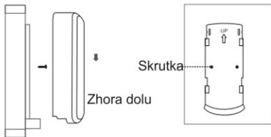
**Poznámka:** Detektor vibrácií musí byť inštalovaný na chránených objektoch a upevnený skrutkou na vibračnú dosku; ak počet vibrácií dosiahne v určitom čase prahové hodnoty alarmu, detektor odošle do poplachovej centrály bezdrôtový signál.
