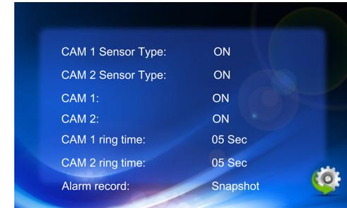
[Sensor-Typ ]: Jeder Kamerakanal entspricht einem I/O-Status (siehe folgende Statuserklärungen), d. h., der ausgelöste Alarm aktiviert den entsprechenden Kanal, um die Aufnahme zu starten oder ein Bild aufzunehmen.
