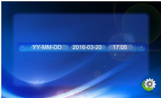
Bewegen Sie den Cursor im Systemmenü auf „Time“ und drücken Sie „\*“, um das Menü „Time“ (Menü „Zeit“) aufzurufen. Verwenden Sie dieses Feld, um das Datumsformat „JJ-MM-TT“ oder „TT-MM-JJ“ umzuschalten und das Systemdatum und die Systemzeit einzustellen. Drücken Sie zuerst „▲“ nach oben oder unten, um den Cursor zu bewegen, drücken Sie „\*“, um eine Option auszuwählen, und scrollen Sie „▲“ nach oben oder unten, um die Werte anzupassen. Drücken Sie zur Bestätigung auf „\*“.
