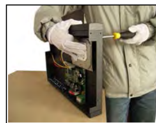
3. Należy zainstalować twardy dysk SATA
