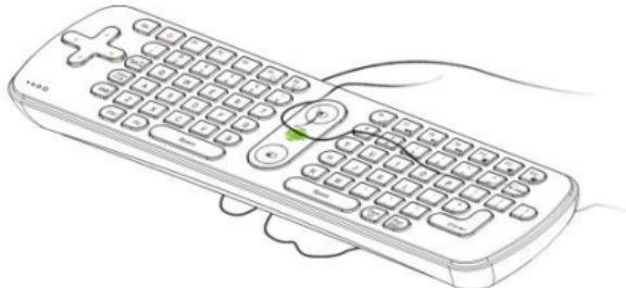
Abyste aktivovali klávesnici, vložte USB přijímač do Vašeho multimedialního přehrávače a zmáčkněte prostřední tlačítko se zelenou ikonou Androidu.
