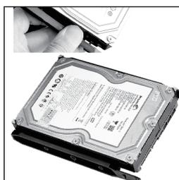
Inserire la consola HDD nell'estensione.
