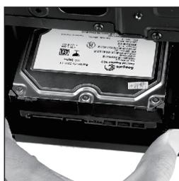
Inserire la consola HDD nell'estensione
